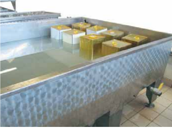
Şekil 2: Kristalleşmiş balın sıcak su banyolarında bekletilerek çözdürülmesi işlemi
