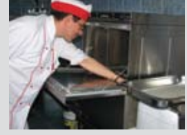
İŞLEM 2: Makinenin temizliği ve kontrolü yapılır. Gider vanası kapatılır. Filtreler kontrol edilir.
